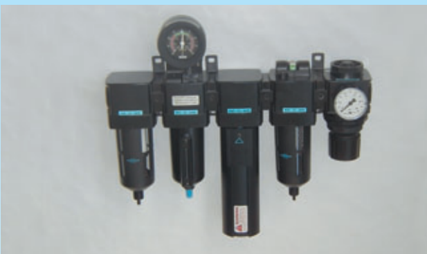
Luftaufbereitung für optische Instrumente mit Vorfilter, Feinfilter mit Differenzdruck-Manometer, Membrantrockner, Aktivkohlefilter und Druckregler.
